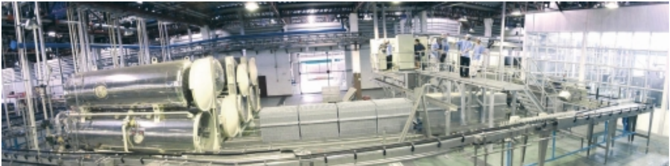
Vollautomatische Sterilisationsanlage Automated batch retort system / Thailand
